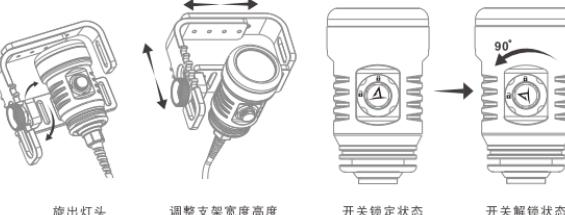
2. **开关机：**装入电池，对准定位孔，拧紧连接处，解锁并按下开关按钮可开启手电。
